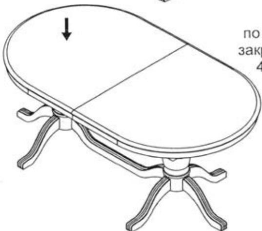
Установить крышку стола по шкантам на опоры с ножками, закрепить снизу через крестовины 4-мя "шурпами-саморезами".
