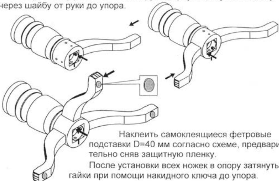
Наклеить самоклеящиеся фетровые подставки D=40 мм согласно схеме, предварительно сняв защитную пленку.
