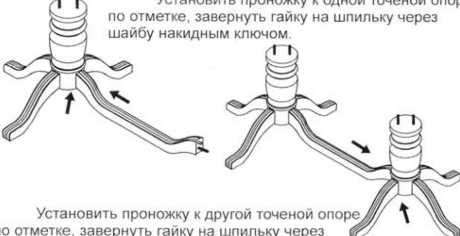
Установить проножку к другой точеной опоре по отметке, завернуть гайку на шпильку через шайбу накидным ключом.
